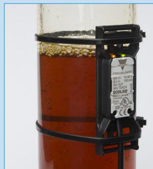
Las sustancias viscosas y pegajosas, como sirope y leche son susceptibles de adherirse a las paredes de los depósitos y generan detecciones erróneas. Los sensores CD34 diferencian entre el nivel del líquido y la película residual.
