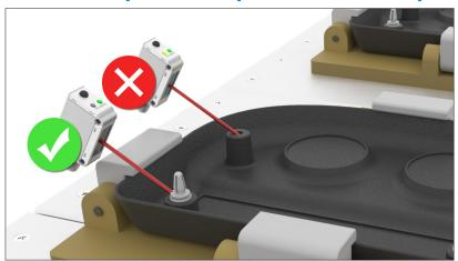
Les petits spots laser rouges ronds visibles d'1 mm sont dirigés vers la surface de l'arrière-plan, sans clips, et sont programmés en mode de suppression du premier plan pour reconnaître l'arrière-plan lui-même. Si les clips sont correctement montés, ils empêchent le capteur de voir l'arrière-plan et sont détectés.
