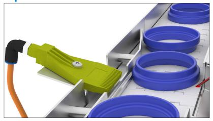
Le petit spot laser rouge rond visible d'1 mm est dirigé vers la bande transporteuse blanche et programmé en mode de suppression du premier plan pour reconnaître la bande. Si une pièce est retournée et que, par conséquent, son plus grand diamètre qui repose directement sur la bande empêche le capteur de voir la bande, la buse de soufflage se déclenche et renvoie la pièce dans le convoyeur.
